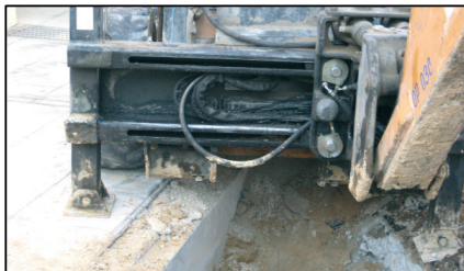
Apoyo sobre dos superficies de diferentes resistencias.
